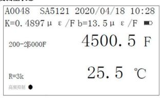
测量单支振弦式传感器时将测量连接线快速插头插在读数仪的左边插座上,将连接电缆夹子按颜色对应连接上传感器的输出电缆,白、绿测温度,红、黑(地)测频率,(黑(地)共用1个夹子)。
