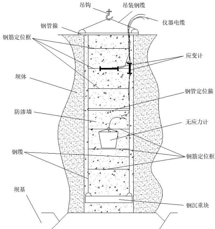
(图 3) 防渗墙中埋设应变计的方法示意图
