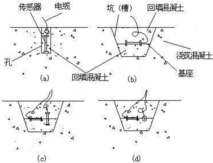
(图 1) 单向和双向应变计埋设示意图
