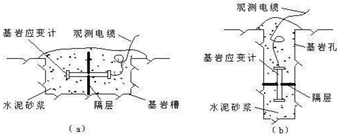
(图 1) 基岩应变计埋设示意图
